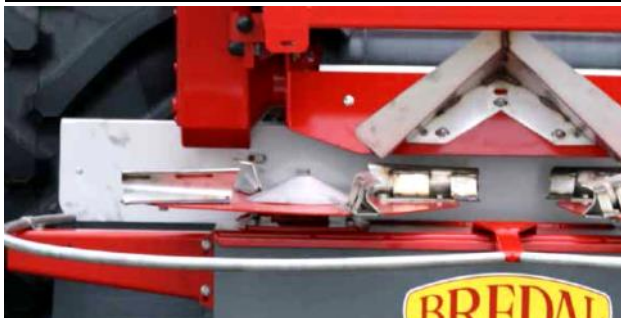
Unité SPC 4500-2, plateaux 4 pales, épandage chaux 10-12m et engrais 12-24m de l'extérieur vers l'intérieur
