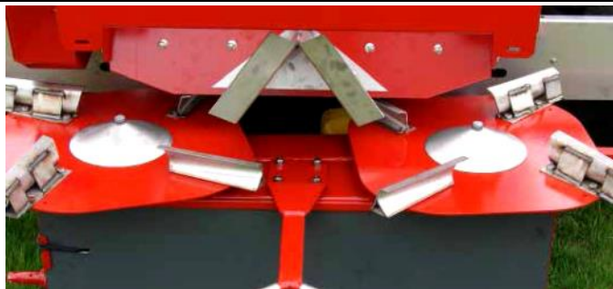
Unité SPC 4500-2 R, plateaux 4 pales, épandage produits grossiers de l'intérieur vers l'extérieur
