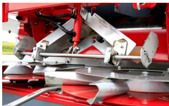
Unité SPC 4500-2, plateaux 4 pales, épandage chaux 10-12m et engrais 12-24m de l'extérieur vers l'intérieur
